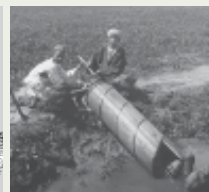
เครื่องสูบน้ำแบบสกรูหมุน โดยใช้แรงคน
