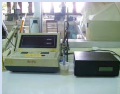
ขนาดของเครื่องวัดการนำไฟฟ้าที่พัฒนาขึ้น เทียบกับเครื่องวัดจากต่างประเทศ
