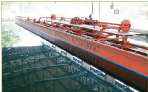
เป็นเครื่องมือสร้างคลื่นทะเลจำลองที่สามารถกำหนดดูป่างทิศทาง ความสูงคลื่น และคาดความถี่ได้ตามต้องการ โดยใช้มอเตอร์ไฟฟ้าขนาด ๗ แรงม้า แบบปรับความเร็ว robust และกระดานตีคลื่นความสูง ๐.๙๐ เมตร ความยาว ๓๐ เมตร โดยมอเตอร์ไฟฟ้าจะทำหน้าที่ขับเคลื่อนขั้กดันกระดานตีคลื่นซึ่งช่วงขั้กและความเร็วของลมมอเตอร์ สามารถปรับเปลี่ยนได้ออกแบบและผลิตโดยกองโรงงาน เพื่อใช้ในการศึกษา
