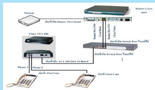
การติดตั้งระบบโทรศัพท์ VoIP
