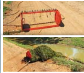
▲ RADA Gate Model II ประตูอัตโนมัติ กลางคลองไฟเบอร์กลาสแบบปรับบานอัตโนมัติ ไร้ต่อมอกัดขวางการไหลของน้ำในคลองแห่งแรกของประเทศไทย พัฒนาขึ้นโดยสำนักวิจัยและพัฒนา ก่อสร้างที่คลอง 1R-L กม. 2 + 850 โครงการอ่างเก็บน้ำห้วยหวดอันเนื่องมาจากพระราชดำริ จังหวัดสกลนคร
