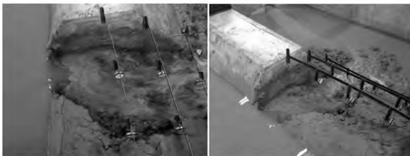
รูปที่ 9 ลักษณะการเกิดช่องขาดของคันดิน
