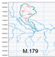
รูป 3 แสดง thiessen polygon และค่าถ่วงน้ำหนักของสถานีวัดน้ำฝนในพื้นที่ลุ่มน้ำย่อยต่างๆ
