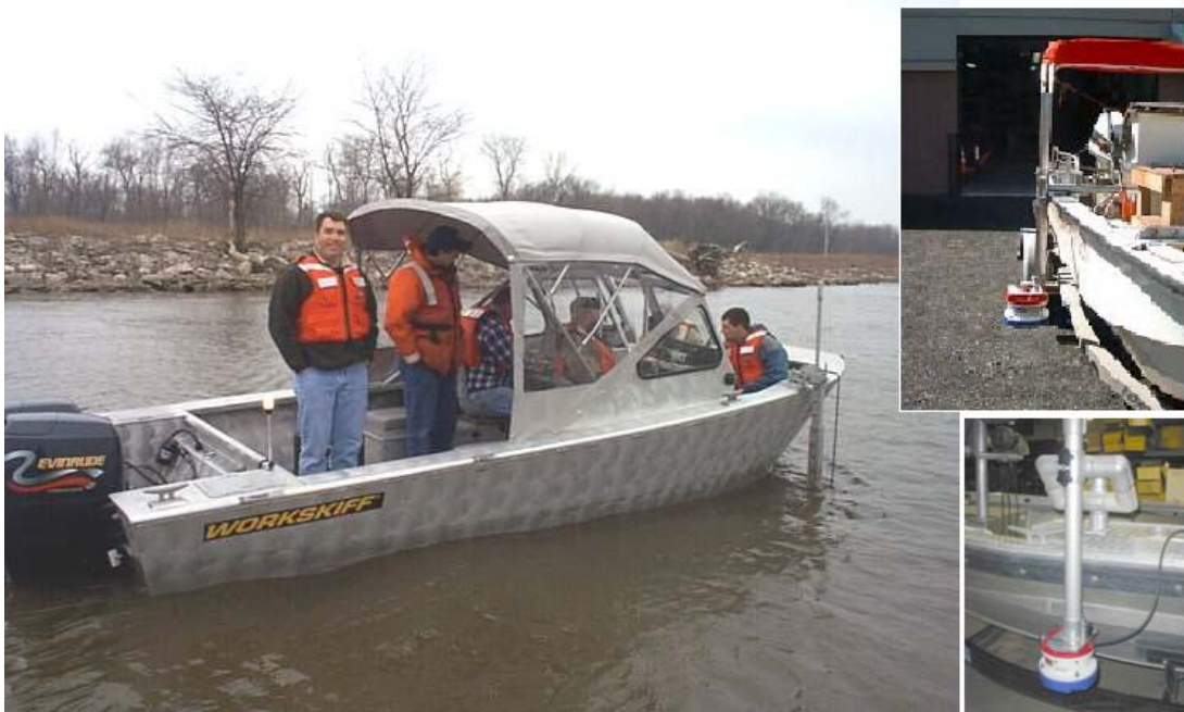
รูปที่ 7 การติดตั้ง ADCP ประเภทติดตั้งกับเรือเคลื่อนที่
