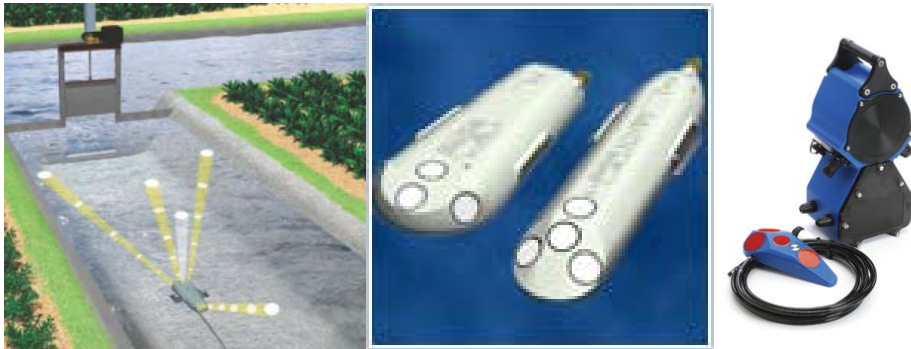
รูปที่ 6 การติดตั้ง ADCP ประเภทติดตั้งที่ก้นลำน้ำ (ซ้าย) เครื่อง ADCP ประเภทติดตั้งก้นลำน้ำ Sontek-IQ (กลาง) และ Vertical ADCP (ขวา)
