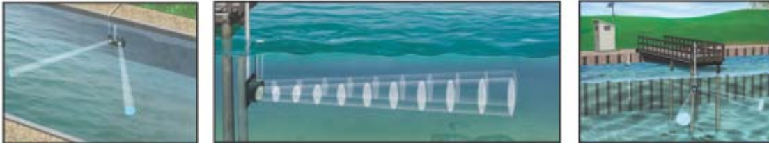
รูปที่ 4 แสดงการติดตั้ง ADCP ประเภทติดตั้งที่ข้างตลิ่ง
