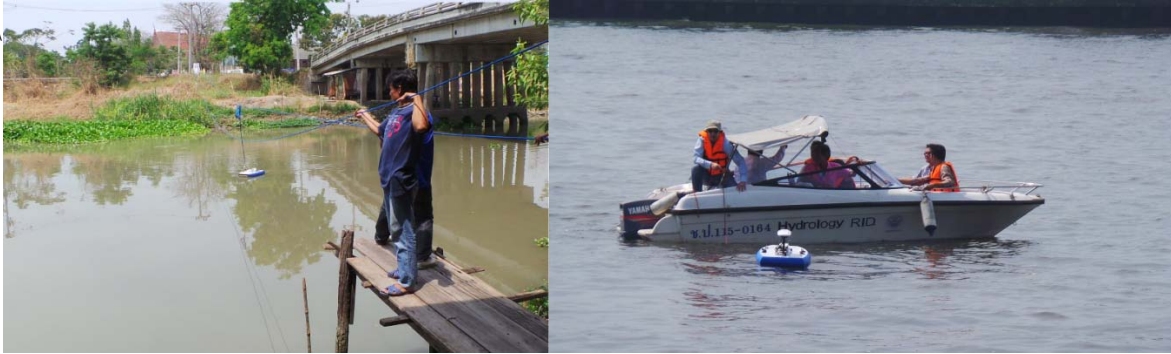
รูปที่ 10 การตรวจวัดปริมาณน้ำด้วยเครื่อง ADCP ประเภทติดกับแพเคลื่อนที่ ในกรณีจึงเชือกแล้วลากตัดลำน้ำ (ซ้าย) และในกรณีลากแพไปกับเรือ (ขวา)
