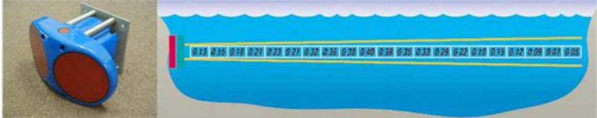
รูปที่ 3 ตำแหน่งตรวจวัดหลายจุดพร้อมๆกันในแนวราบ ซึ่งกำหนดโดยตั้งขนาดของเซลล์ที่จะวัด (cell size) จะ ได้ความเร็วของกระแสในในแต่ละเซลล์ ตลอดแนวหน้าตัดลำน้ำ
