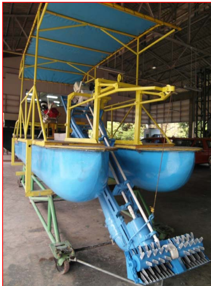
รูปที่ 11 แสดงลักษณะหัวตัด ของเรือเก็บวัชพืชน้ำโมเดล I
