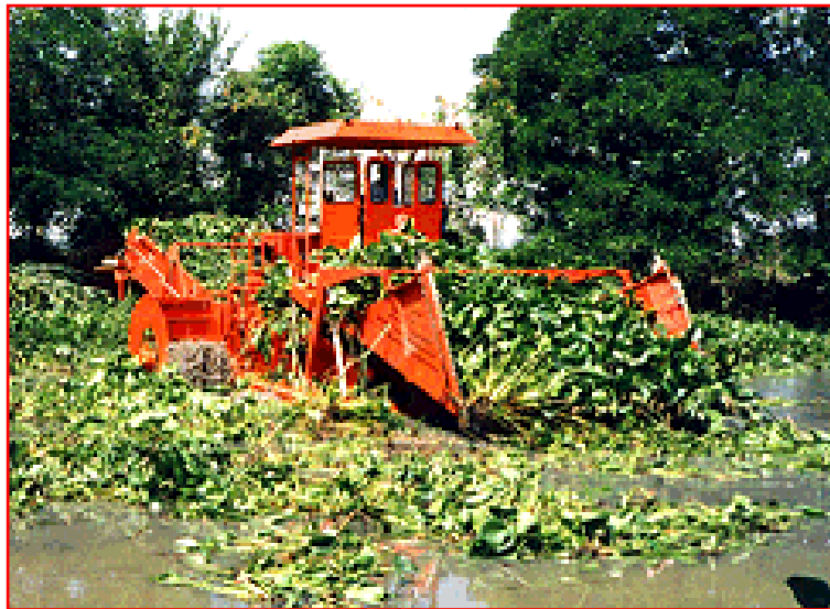
รูปที่ 3 เรือเก็บวัชพืชนขนาดใหญ่ น้ำหนักมาก ค่าขนย้ายสูง การปฏิบัติงานในพื้นที่ขนาดเล็กทำได้ไม่สะดวกและไม่คุ้มทุนในการขนย้ายเครื่องมือไปปฏิบัติงาน
