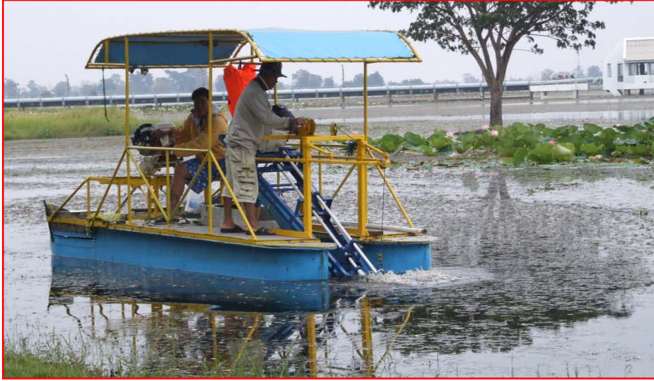
รูปที่12 การทำงานของเรือเก็บวัชพืชน้ำโมเดล I ขณะดูดตัดเก็บสาหร่ายหางกระรอกในอ่างเก็บน้ำ
