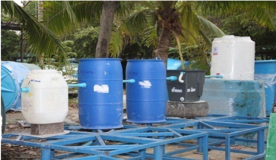
ภาพที่ 3 แบบจำลองการบำบัดน้ำด้วยกระบวนการเอเอส
