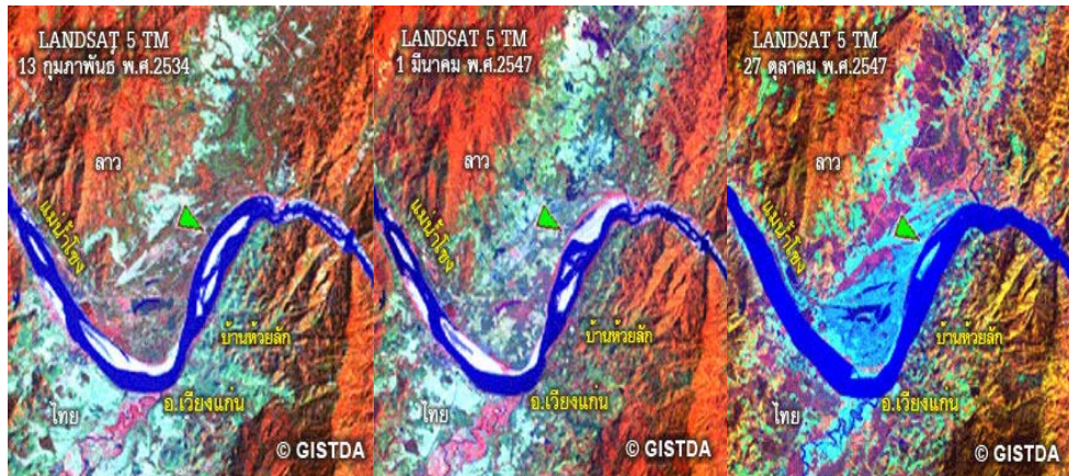
รูปที่ 14 : ภาพจากดาวเทียม LANDSAT 5 ระบบ TM แบนด์ 4 5 1 - แดง เขียว น้ำเงิน เปรียบเทียบสภาพลำน้ำช่วงสร้างเขื่อนและหลังจากเขื่อนเริ่มกักเก็บน้ำบริเวณบ้านห้วยลึก
