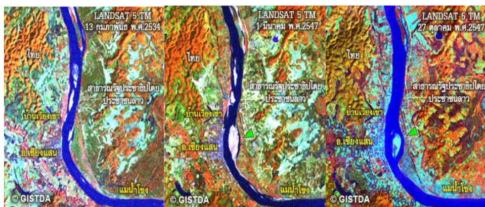
รูปที่ 12 : ภาพจากดาวเทียม LANDSAT 5 ระบบ TM แบนด์ 4 5 1 - แดง เขียว น้ำเงิน เปรียบเทียบสภาพลำน้ำช่วงสร้างเขื่อนและหลังจากเขื่อนเริ่มกักเก็บน้ำบริเวณบ้านเวียงเขา
