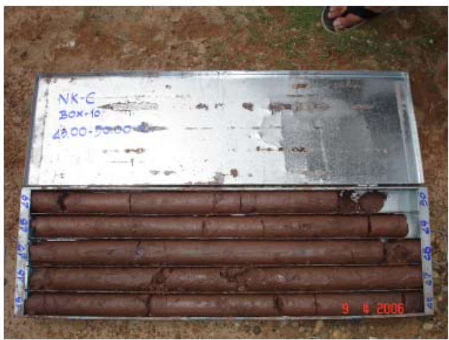
แท่งดินตัวอย่างของหลุมเจาะ ความลึก 200 เมตร
