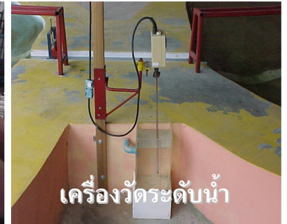
ภาพที่ 3 แบบจำลองที่สร้างย่อมาตราส่วนจากของจริง 1:100 ในแนวตั้ง และ 1:500 ในแนวนอน มีขอบเขตตั้งแต่บริเวณสะพานแขวนพระราม9 ถึง ท่าเรือพระประแดง และเครื่องมืออุปกรณ์ในการทดลอง
