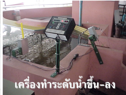
ภาพที่ 3 แบบจำลองที่สร้างย่อมาตราส่วนจากของจริง 1:100 ในแนวตั้ง และ 1:500 ในแนวนอน มีขอบเขตตั้งแต่บริเวณสะพานแขวนพระราม9 ถึง ท่าเรือพระประแดง และเครื่องมืออุปกรณ์ในการทดลอง
