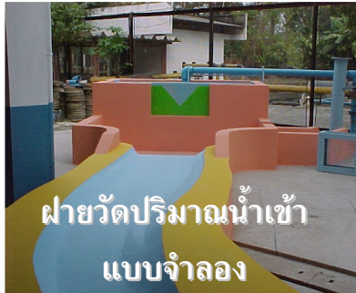
ภาพที่ 3 แบบจำลองที่สร้างย่อมาตราส่วนจากของจริง 1:100 ในแนวตั้ง และ 1:500 ในแนวนอน มีขอบเขตตั้งแต่บริเวณสะพานแขวนพระราม9 ถึง ท่าเรือพระประแดง และเครื่องมืออุปกรณ์ในการทดลอง
