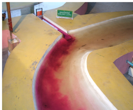
ภาพที่ 4 สภาพการไหลของน้ำออกจากปลายคลองลัดโพธิ์สู่มแม่น้ำเจ้าพระยา จากการทดลองในแบบจำลอง (โดยใส่สีเพื่อตรวจสอบสภาพการไหลของน้ำ)
