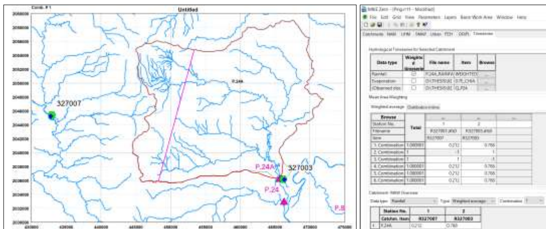
ภาพที่ 3 การสร้างพื้นที่รับน้ำและรูปเหลี่ยมโพลีโงนของสถานีวัดน้ำท่าสะพานประชาอุทิศ (P.24A)
