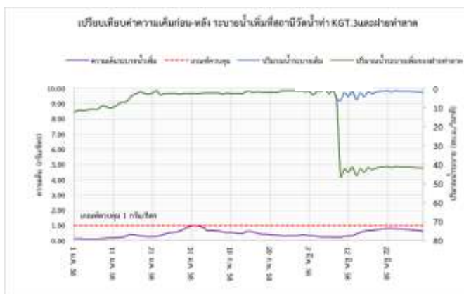
รูปที่ 9 เปรียบเทียบค่าความเค็มก่อน-หลัง เพิ่มปริมาณน้ำผ่านที่สถานีวัดน้ำท่า KGT.3 30 ลบ.ม./วินาที และระบายเพิ่มจากฝายท่าลาด 40 ลบ.ม./วินาที ตั้งแต่วันที่ 10 มี.ค. – 31 มี.ค. 58 ที่จุดควบคุม ปตร.บางขนาก สรุปผลการศึกษา
