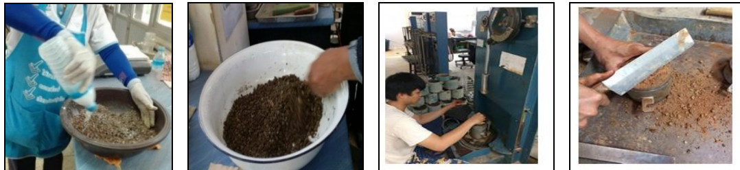
ภาพที่ 2 ผสมตามอัตราส่วนคลุกเคล้าให้เข้ากัน ภาพที่ 3 บดอัดแต่งตัวอย่างและแต่งผิวให้เรียบ
