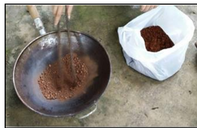
ภาพที่ 9 เก็บตัวอย่างดินหาความชื้นดินเดิม
