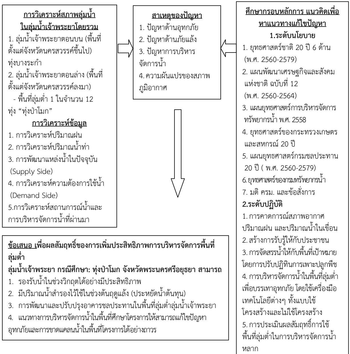
รูปที่ 2 กรอบหลักการ แนวคิดของการบริหารจัดการพื้นที่ลุ่มต่ำเพื่อรองรับปริมาณน้ำหลากในลุ่มน้ำเจ้าพระยา กรณีศึกษา: ทุ่งป่าโมก จังหวัดพระนครศรีอยุธยา
