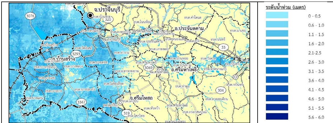
รูปที่ 14 ผลการวิเคราะห์พื้นที่น้ำท่วมในเขตจังหวัดปราจีนบุรี ที่รอบปีการเกิดซ้ำ 10 ปี
